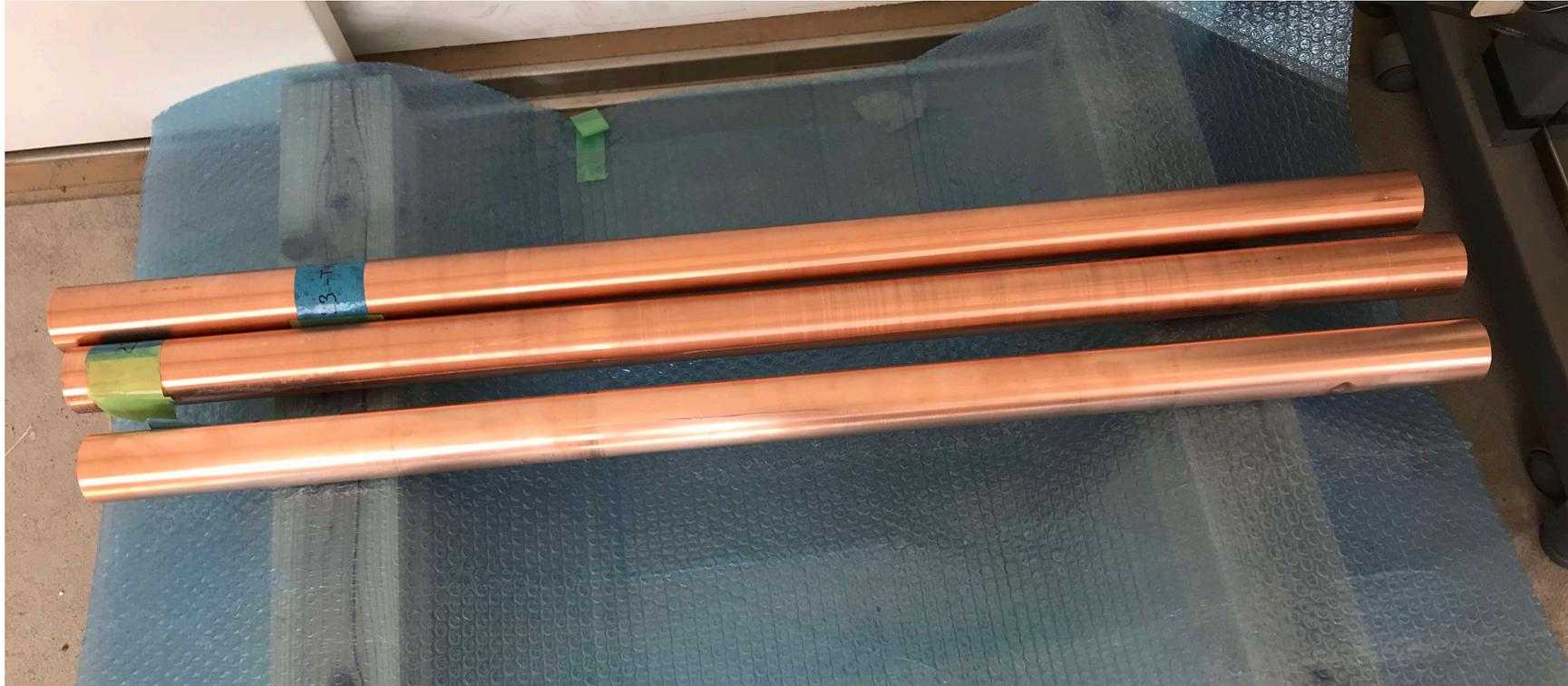
鑄造材を鍛造、熱処理して、表面を切削した銅銀棒が完成。
